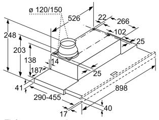
Tiefenanpassung des Filterauszuges bis 29 mm möglich
